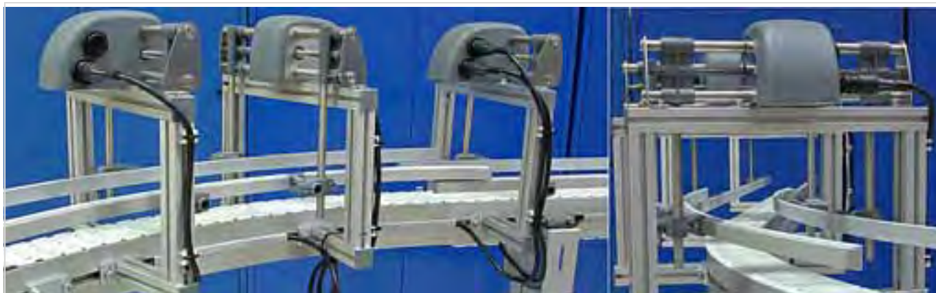
Секции направляющих рельсов должны заходить одна за другую.
