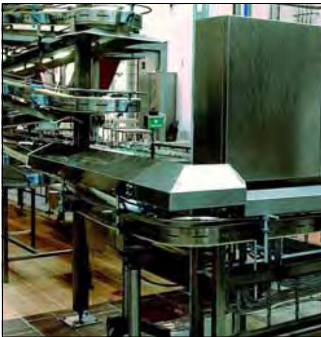
Вертикальный промежуточный накопитель
